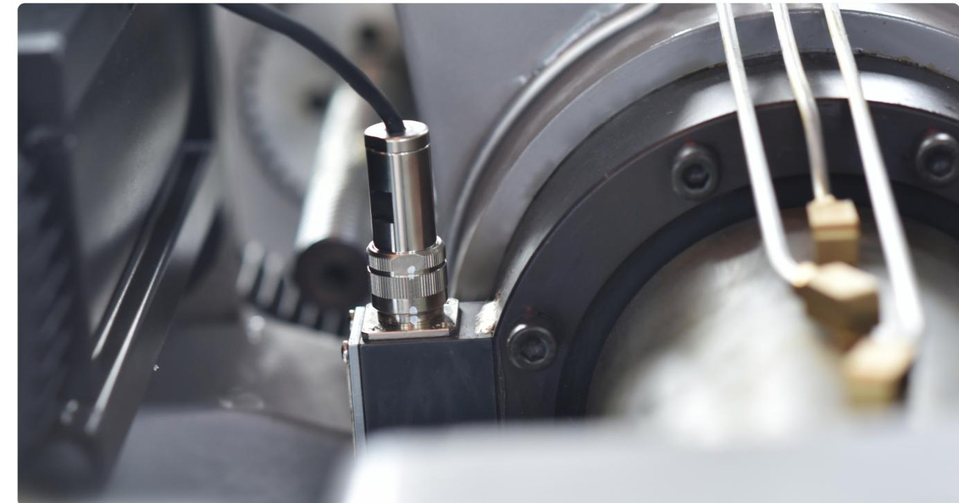
通过高速计算机智慧运算，在注射的过程中极速监察螺杆的运动状态 (<1ms)，并配合高速压力感测器资料，利用专利排气泄压机构设计使高速运动中所产生的良品率的内应力得以释放，保证了产品超高合格率。
