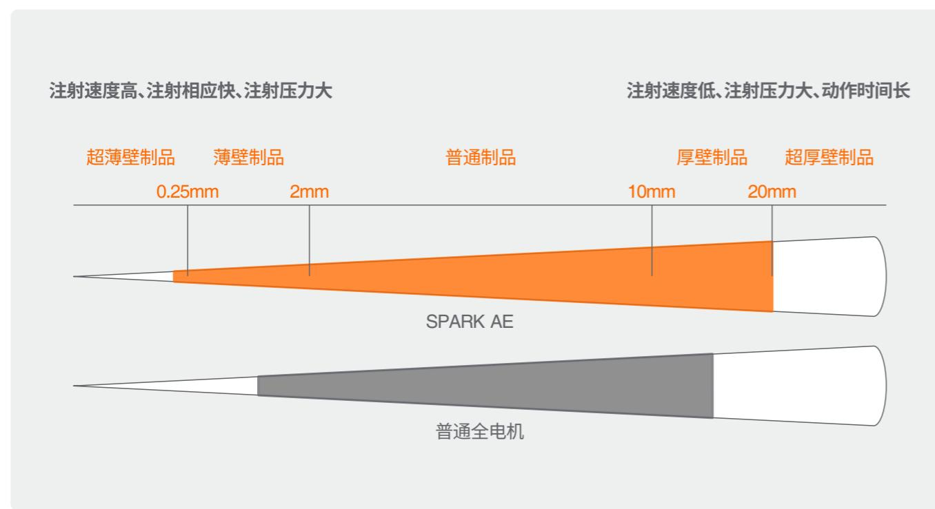
SPARK AE系列全电机通过严苛的指标溢出要求，最终兼顾超薄壁制品的超高速注射和超厚制品的高压保持要求，无论是光学透镜还是薄壁包装，都能轻松应对。
