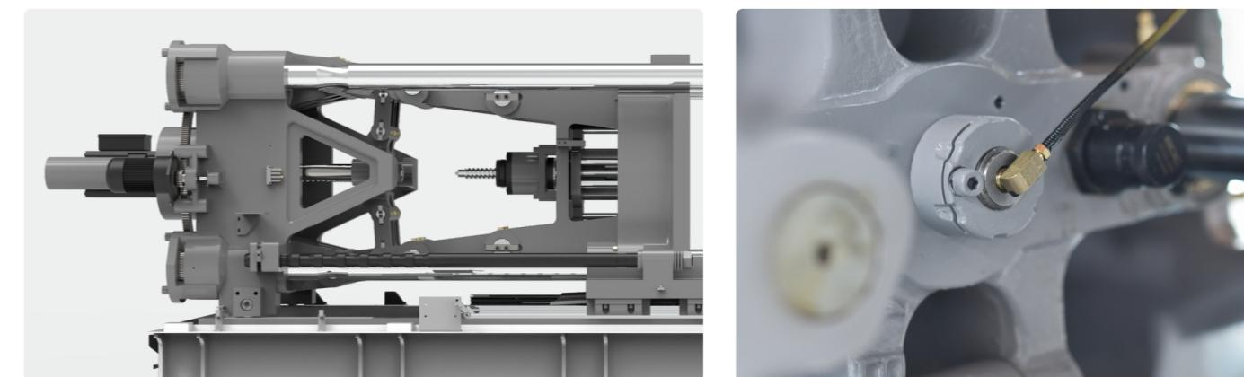
智能联动保护是一套基于精密结构设计，加上先进计算机算法，对高速相向的模具进行防撞保护的安全系统。通过高速计算机控制系统对滚珠丝杠进行动态调整，使合模动作如双手合十般恰当好处，不仅保护模具，更节省电力。
