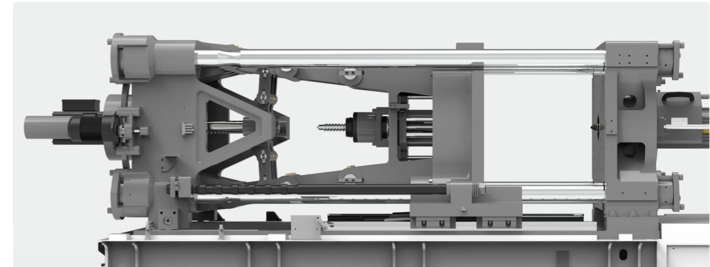
合模二板销轴孔更靠近中心，利于将合模力传递到二板中心，实现均衡的合模力分布；高强度二板，刚性大，模板变形量小。
